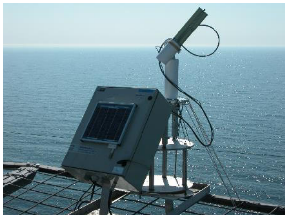
Radiometru oceanic instalat la Platforma "Secția 7"
